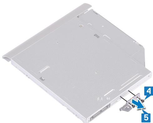
6. Tire del embellecedor de la unidad óptica para retirarlo de la unidad óptica.
