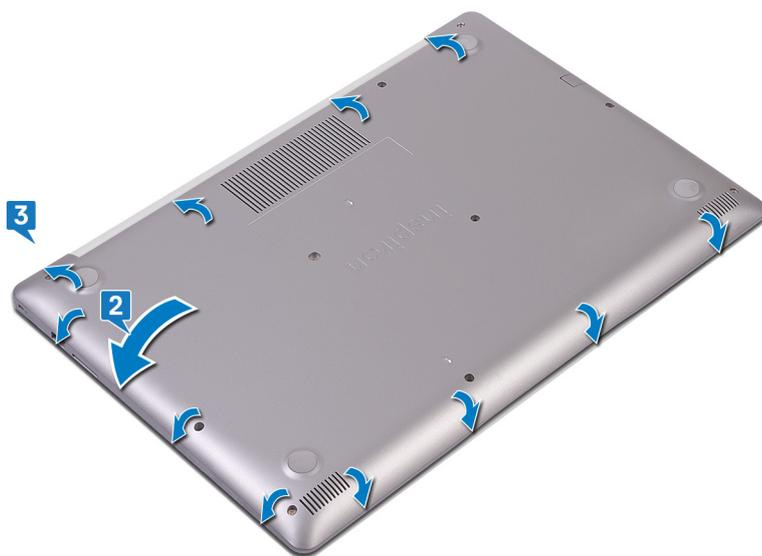
4. Ajuste los tres tornillos cautivos que fijan la cubierta de la base al ensamblaje del teclado y el reposamanos.
